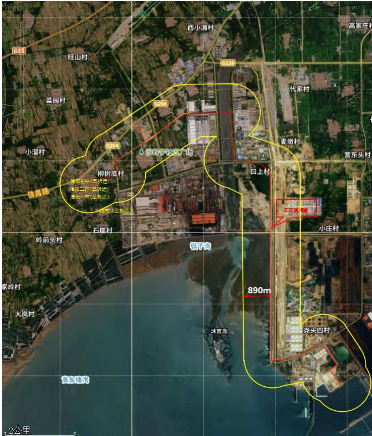
图 9.5-35 最不利气相条件下正丁烷输送管道泄漏事故正丁烷最大影响范围图
