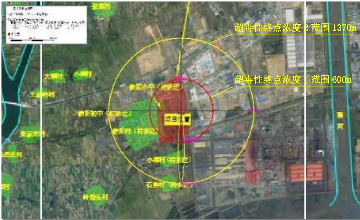
图 9.5-20 最常见气相条件下煤制合成气装置气化炉到洗气塔的输送管道 10%管径断裂泄露事故 CO 影响范围图
